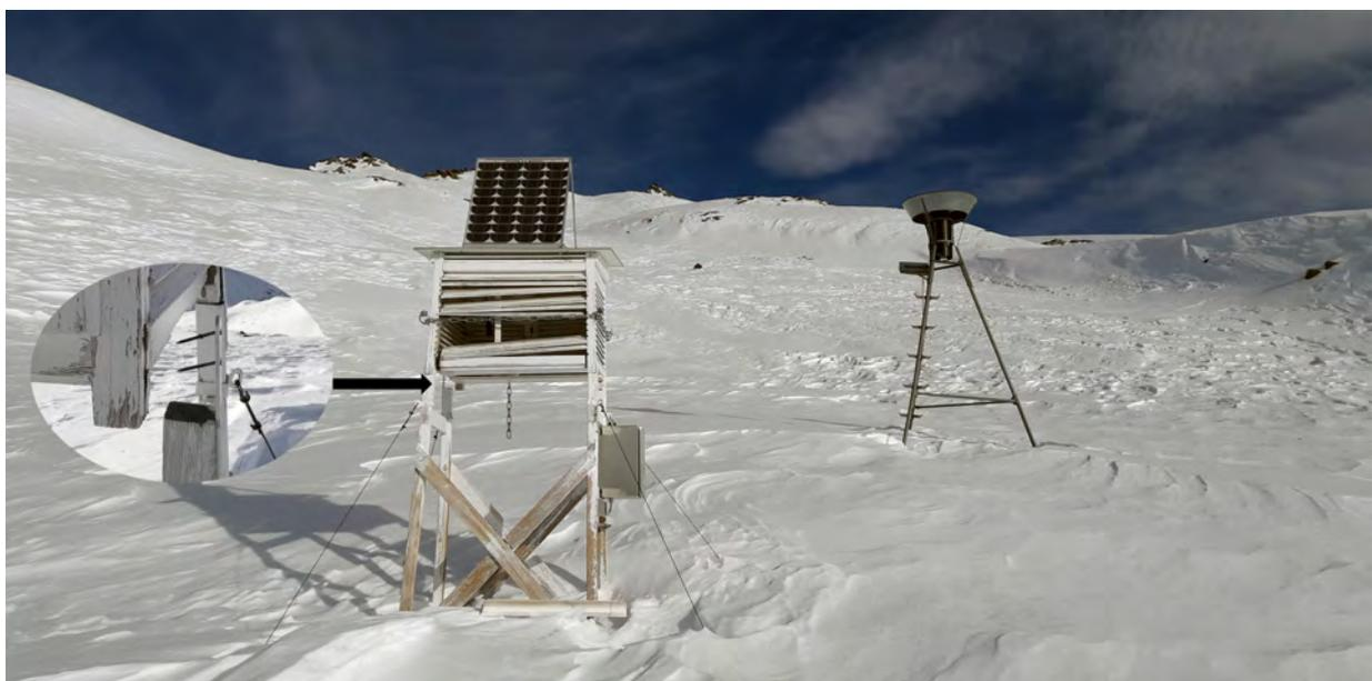
Abbildung 3: Durch Wind beschädigte Wetterhütte am 03.01.2020.
