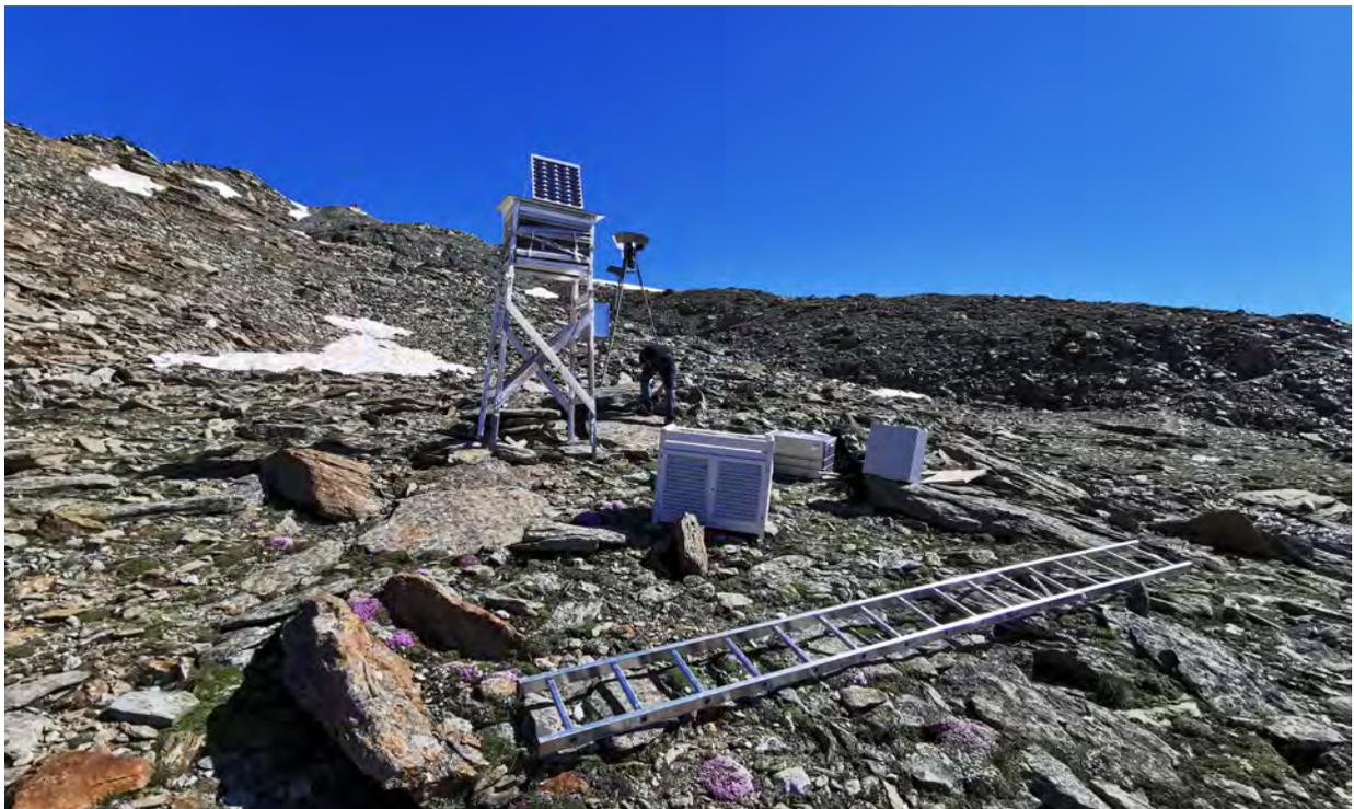
Abbildung 13: Aufbau der neuen automatischen Wetterstation am 09.08.2020 (Foto: A. Gschwentner).
