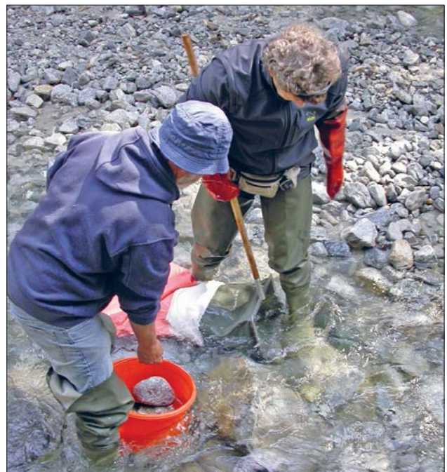
Probennahme im Feld mittels Surbersammler: in der Strömung werden damit an einer gezielt ausgewählten Stelle die driftenden Tiere eingesammelt und später im Labor bestimmt (Foto: G. ANDRE).
