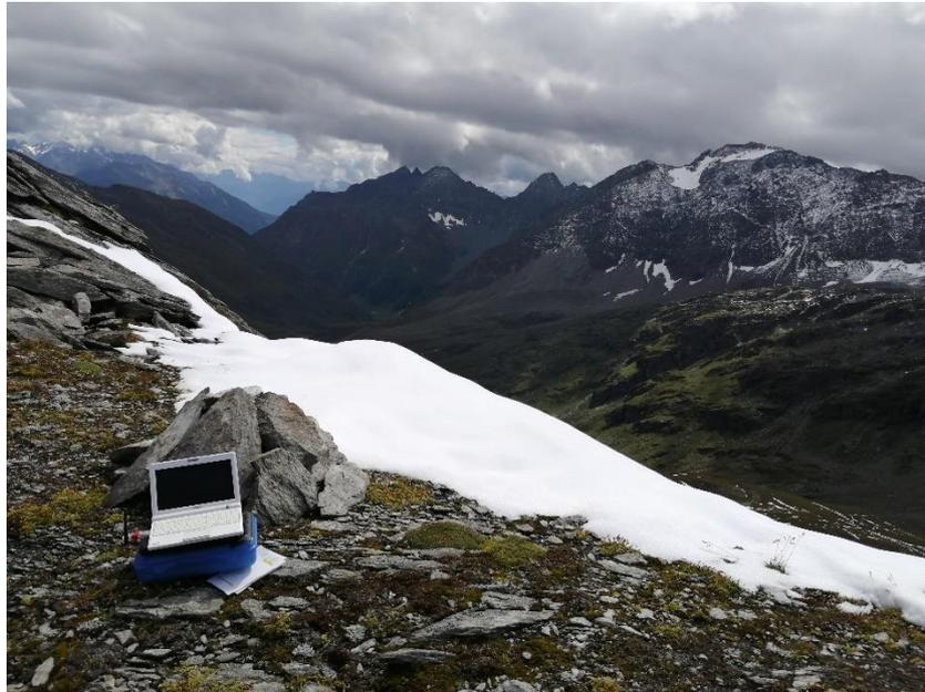
Abbildung 2: Auslesen der Temperaturdaten via Funkschnittstelle (als schwarzer Stift am Foto links vom Laptop erkennbar) wie hier beispielhaft gezeigt am Standort G-1K-E-2845. Das Frossnitztal ist im Bildhintergrund zu erkennen. Blick nach Süden. Foto: Andreas Kellerer-Pirklbauer.
