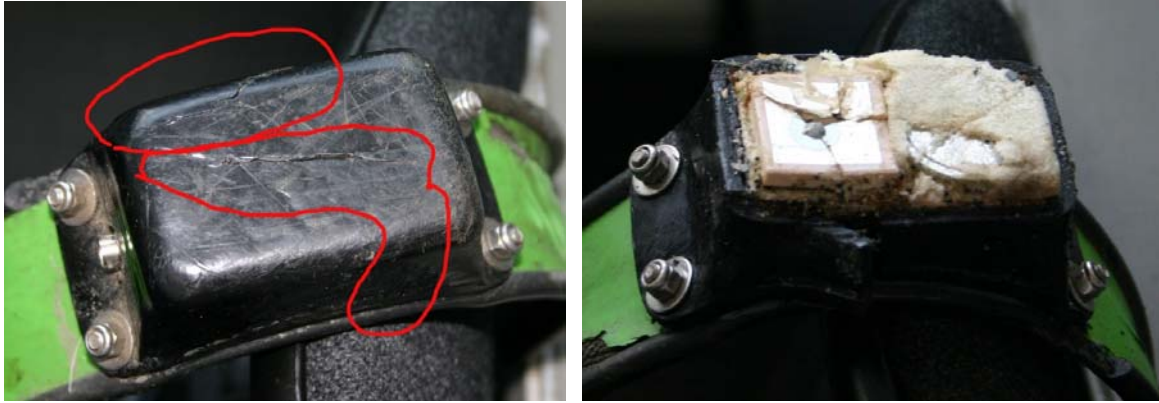
Abbildung 4: Beschädigungen des Halsbandes 1521 durch äußere Gewalteinwirkung (Fotos: Vectronic Aerospace)
