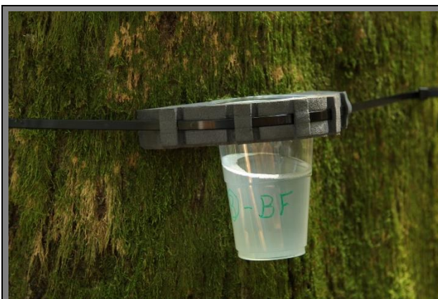
Abbildung 3: Eine Baumfalle an der Basis der kartierten Rotbuche (Scheibenbauernalm). Mit einer formbaren Verbindungsmanchette wurde der Fallenbecher am Baumstamm fixiert. [Foto: J. Lamprecht, ÖKOTEAM]
