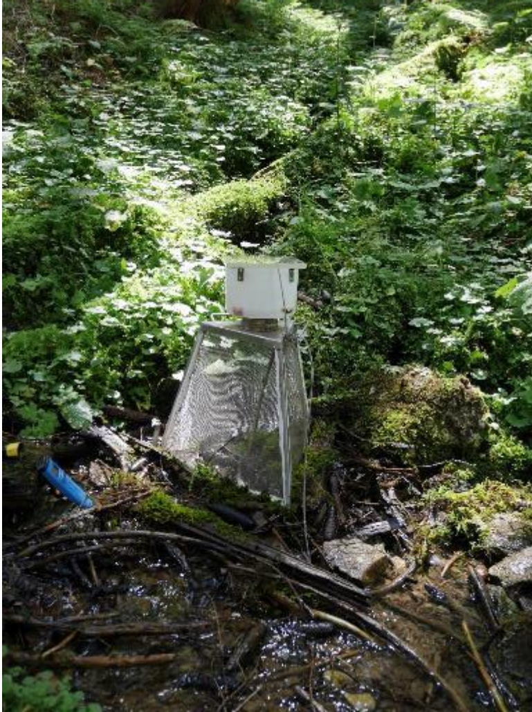
Abbildung 5: Emergenzfalle im Quellbach am Brucksattel mit Leitfähigkeitsmessgerät (links im Bild). - Foto: C. Remschak, 11.08.2024
