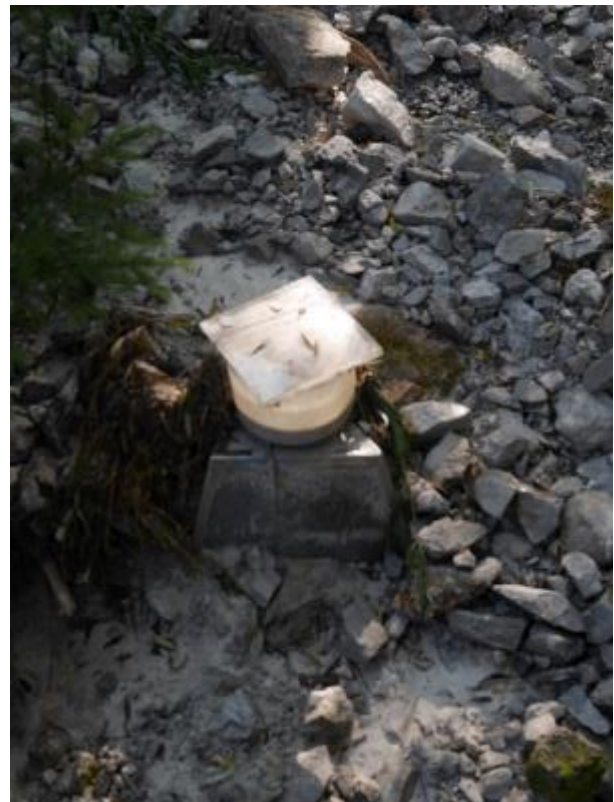
Abbildung 13: Steine, Sand und Dolomitschlamm begruben die Emergenzfalle zur Hälfte, beschädigten sie aber kaum. – Foto: C. Remschak, 16.08.2024
