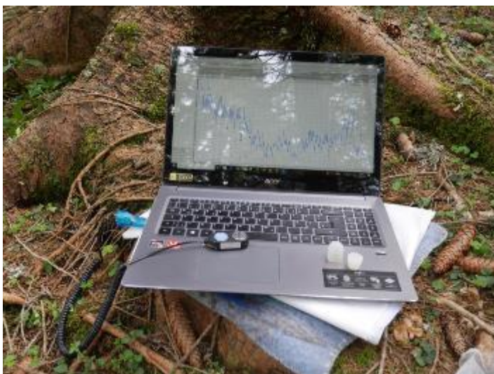
Abbildung 1: Auslese der Temperatur-Logger mittels Laptop. - Foto: C. Remschak, 28.04.2024
